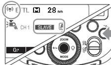
Drücken Sie die <RECEIVER>-Taste so, dass <RECEIVER> auf dem LCD-Display angezeigt wird.
