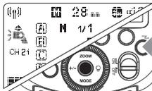
Drücken Sie die <F>-Taste so, dass <F> auf dem LCD-Display angezeigt wird.
