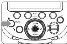
1 Mit der Funktionstaste 1/2/3/4 wird die Gruppe M/A/B/C gesteuert. Durch kurzes Drücken der Funktionstaste kann aus i-TTL/M/OFF ausgewählt werden. Wählen Sie einen davon als Blitzmodus des Transmitter-Gerätes.
