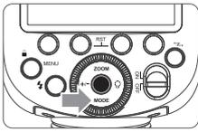
**1** Drücken Sie die <MODE>-Taste, so dass <MULTI> angezeigt wird.
