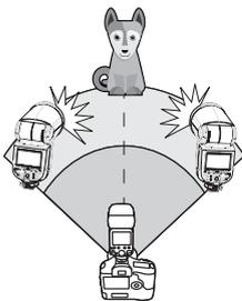
Wenn Sie mehr Blitzleistung oder die Belichtung vereinfachen möchten, können Sie die Zahl der Receiver-Einheiten erhöhen und die als eine Receiver-Einheit festlegen. Sie können weitere Receiver-Einheiten hinzufügen, indem Sie die Schritte unter „Automatische drahtlose Blitzaufnahmen mit einer Receiver-Einheit“ durchführen. Jede Blitzgruppe kann als (A/B/C/D/E) festgelegt werden.
