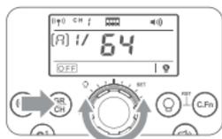
1. Halten Sie die Taste <GR/CH> 2 Sekunden lang gedrückt, die Kanalnummer wird blinkend angezeigt.
