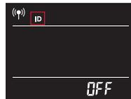
**蓝牙重置:** 选至蓝牙界面, 长按 CCT/FN 旋钮, 蓝牙符号出现闪烁, 表示正在重置中, 闪烁停止, 蓝牙重置完毕。
