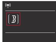
**频道 CH:** 选至频道界面, 短按 CCT/FN 旋钮, CH 出现闪烁, 旋转 CCT/FN 旋钮可选 32 个频道 (1-32)。
