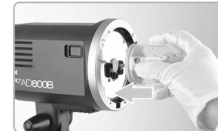
2. Passen Sie die Blitzröhre in der Röhrenbuchse an. Schieben Sie die Blitzröhre hinein, bis sie fest in der Fassung sitzt.
