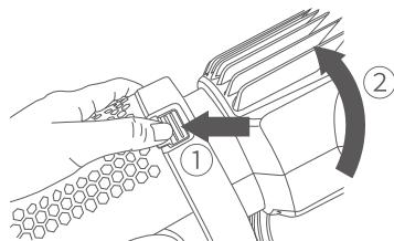
注:LED映像ライトの取付けと取外しは電気を切って行う必要があります。
