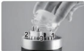
**3** Premièrement, serrez fermement le ressort 1 et appuyez les ressorts 2 et 3 simultanément. Installez ensuite le couvercle de protection du verre.
