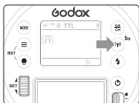
**1** Appuyez longuement sur le bouton sans fil
