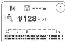
电池电量低时, 电池符号
